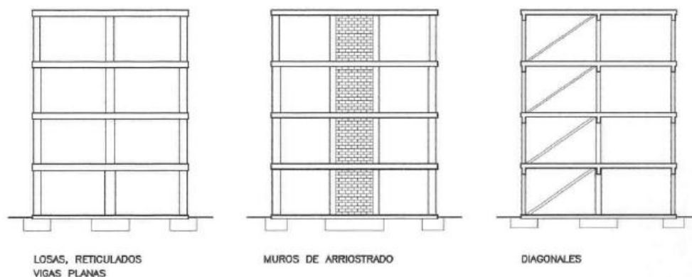
Figura 3.6.- Ejemplos de organizaciones estructurales que permiten un valor del coeficiente de comportamiento por ductilidad \mu = 2 .
