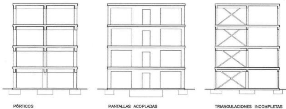
Figura 3.4.- Ejemplos de organizaciones estructurales que permiten un valor del coeficiente de comportamiento por ductilidad \mu = 4 .
