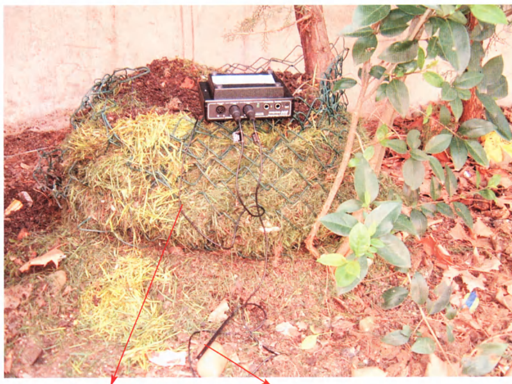
Sensor de temperatura A (compost)
