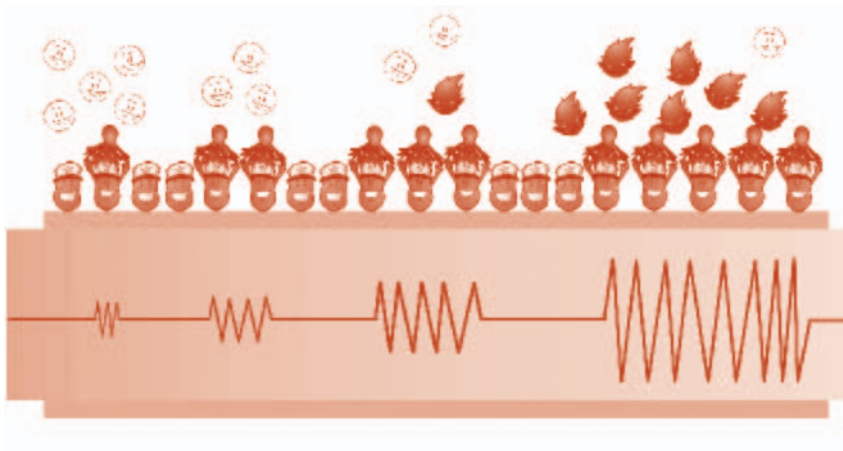
FIGURA 6. Biosensor piezoeléctrico. Como consecuencia de la interacción entre el elemento de reconocimiento y el analito se produce un cambio en la frecuencia de resonancia del cristal.
