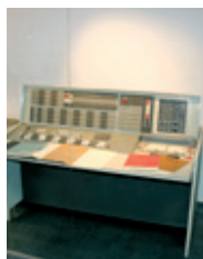
Ordenador IBM, modelo 7090, utilizado en el Centro de proceso de datos de la Universidad Complutense hasta comienzos de la década de 1970.
