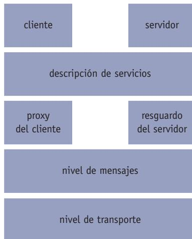
FIGURA 25. Modelo básico en computación orientada a servicios.
