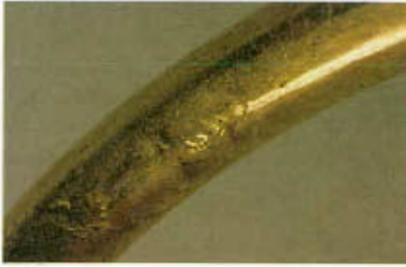
*Su fabricación se realizó a partir de una barra metálica vaciada en molde. Posteriormente la barra fue martillada cuidadosamente, aunque no se pudieron evitar grandes solapamientos de metal, grietas y pequeños hoyos debidos a defectos de fundición.*
