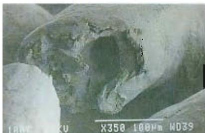
Micrografía de la sección de un hilo hueco de filigrana.
