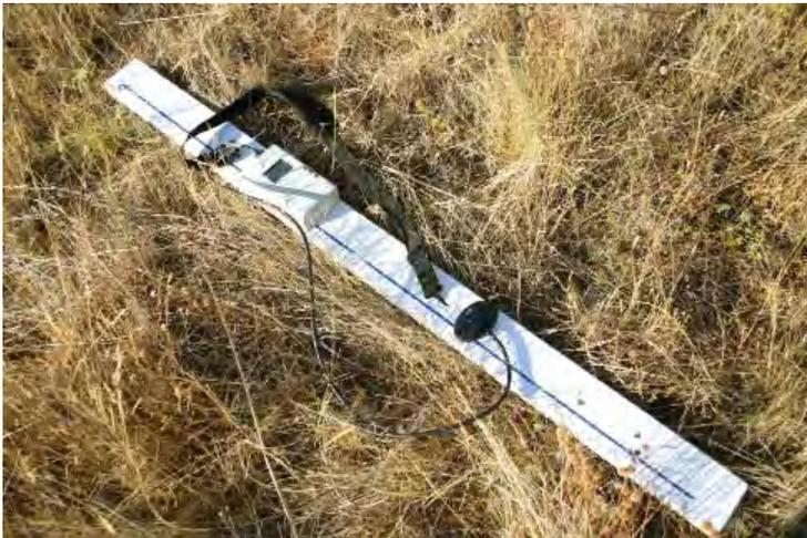
Figura 1. Sensor electromagnético GEM2.
