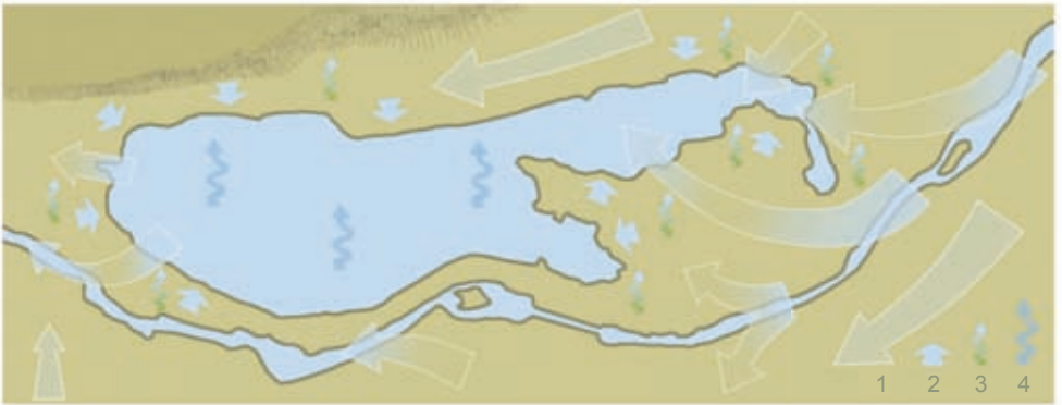
Plano de la laguna y el río con las ganancias y pérdidas de agua. 1. Flujo de agua subterránea; 2. Escorrentía; 3. Evaporación por transpiración de la vegetación; 4. Evaporación de la lámina de agua.
