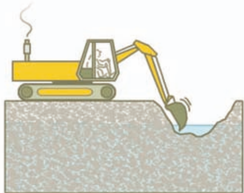
Máquina excavando por debajo del nivel freático.
