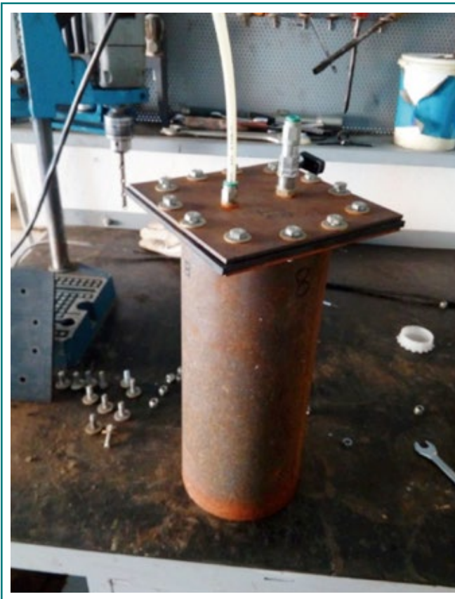
Reactor tipo Bach donde se realizó el ensayo de biogás
