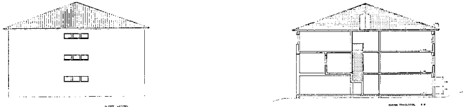
Secciones longitudinal y transversal del edificio principal.
