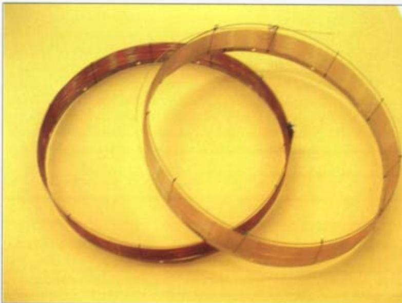
Columnas capilares empleadas para el análisis de los azúcares por cromatografía de gases
