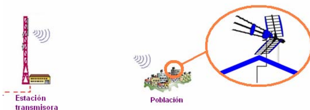
Figura 6. Esquema transmisión-recepción para televisión digital y analógica terrestre.
