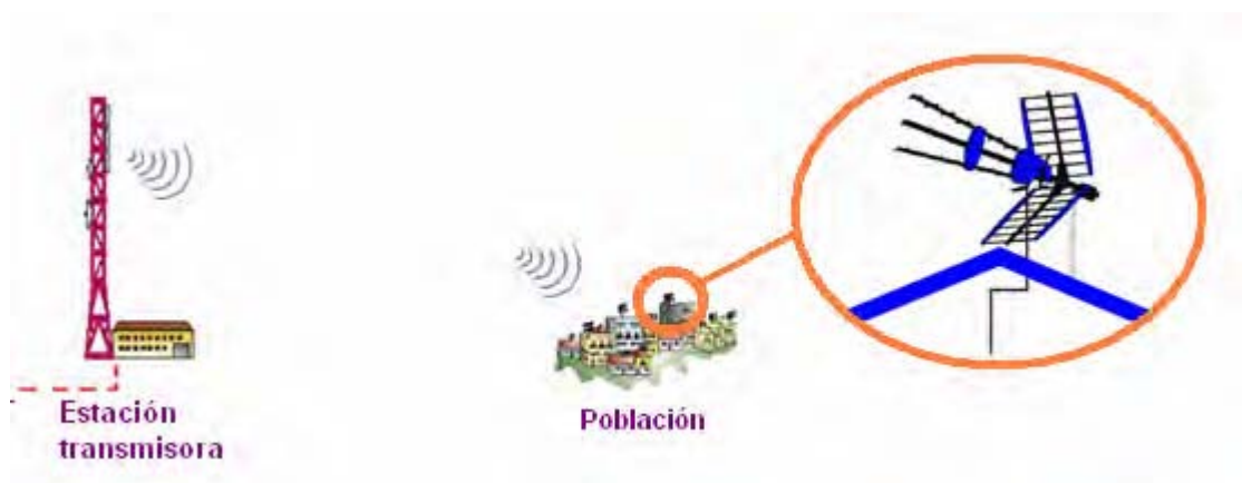
Figura 6. Esquema transmisión-recepción para televisión digital y analógica terrestre.
