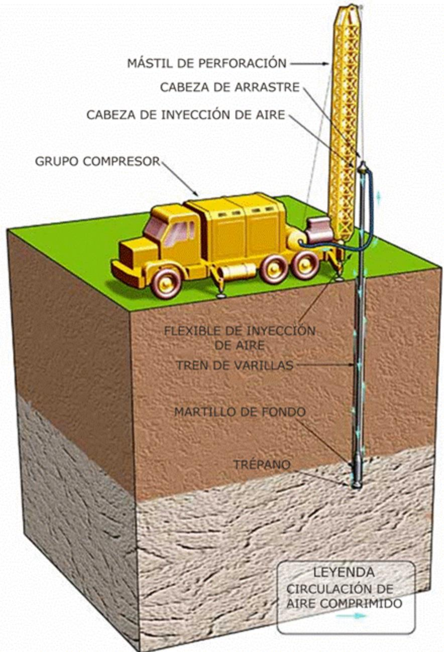
Figura 5.2. Perforación a rotoperforación con martillo en fondo.
