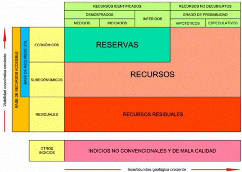
Figura 3.14. Esquema de clasificación de recursos geotérmicos.
