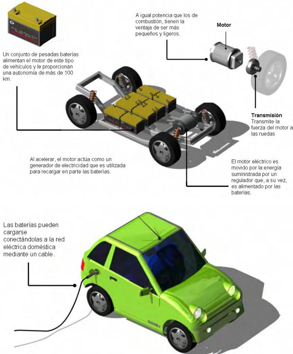
Figura 5.2. Componentes básicos de un vehículo eléctrico.
