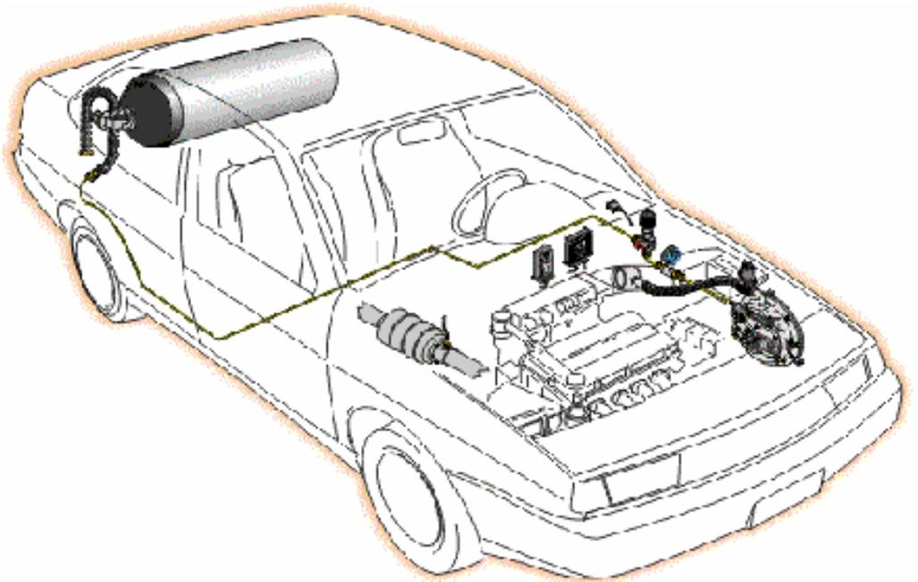
Figura 6.7. Componentes de un vehículo a gas natural.
