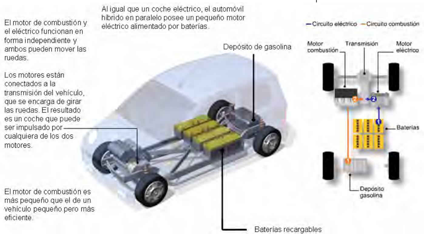
Figura 5.3. Configuración en paralelo.
