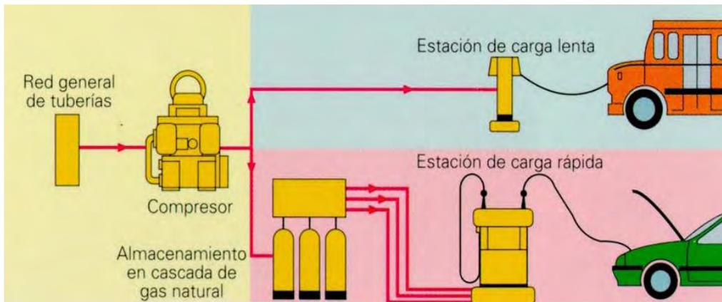
Figura 6.9. Esquema general de carga de GNC.
