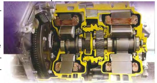
Figura 5.5. Tren motor de un vehículo eléctrico.
