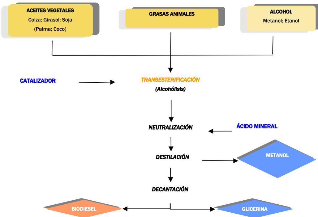
Figura 4.2. Producción de biodiesel.
