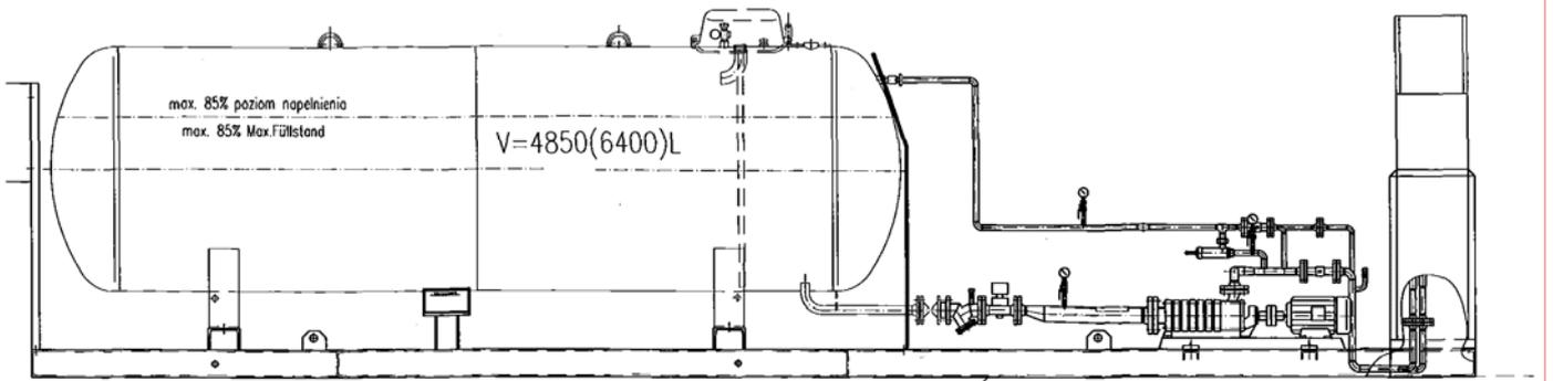
Figura 6.3. Esquema de un skid de GLP.
