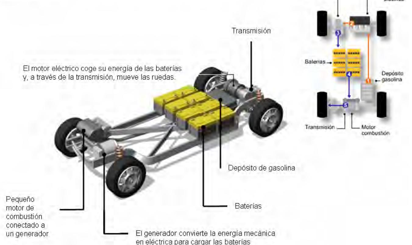
Figura 5.4. Configuración en serie.
