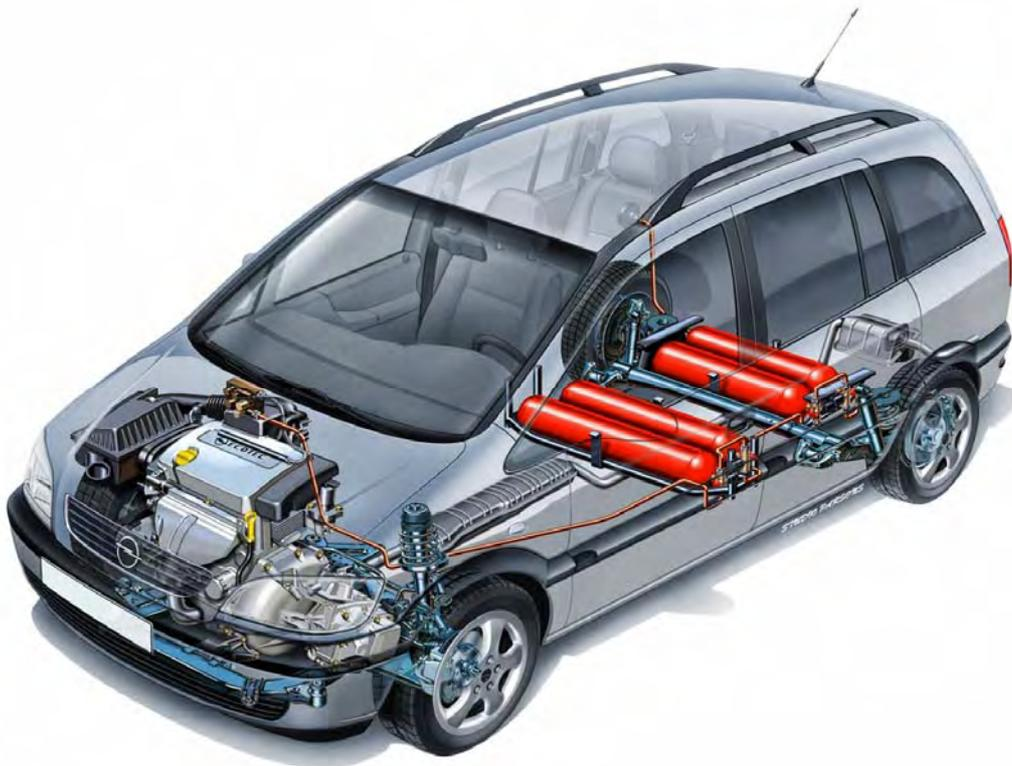
Figura 6.8. Depósitos de gas natural en la parte inferior de un vehículo.
