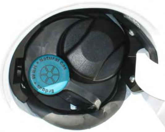
Foto 6.10. Vista de la boca de un depósito de gas natural junto a la del depósito de gasolina.
