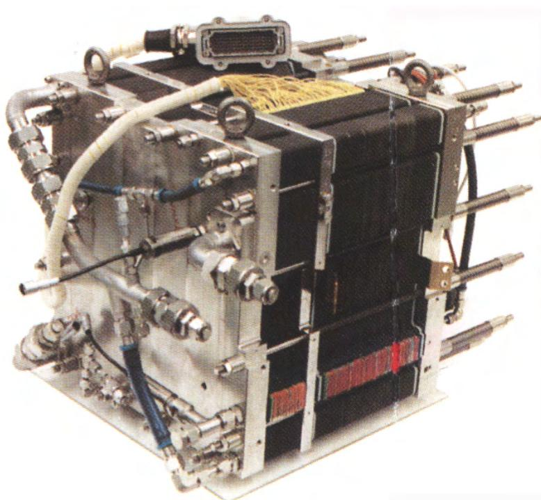
Figura 7.8. Pila de combustible de un autobús de pasajeros.
