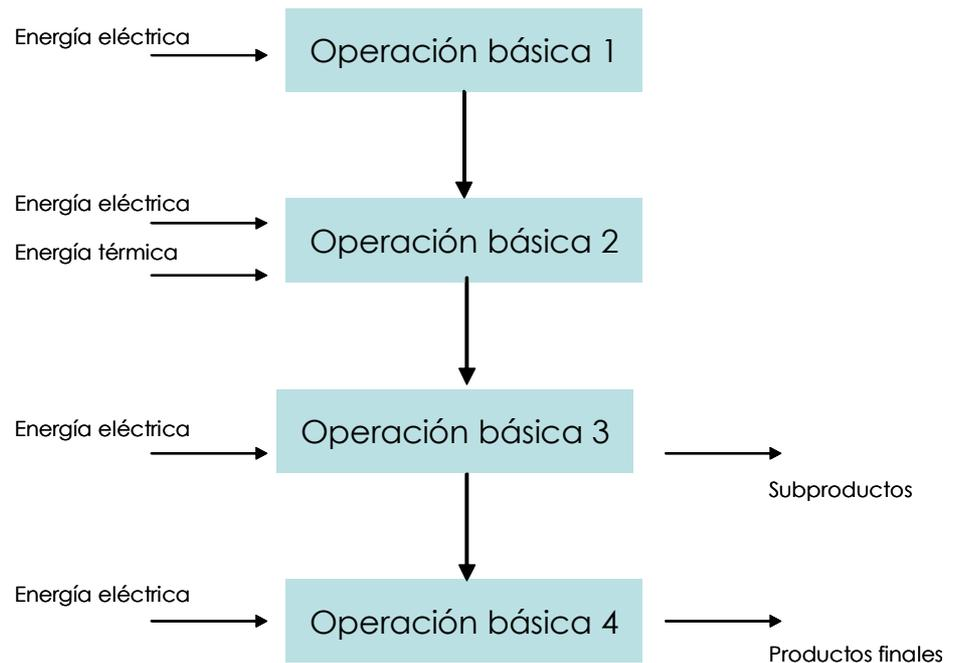
Figura 6.1. Esquema de un diagrama de procesos.
