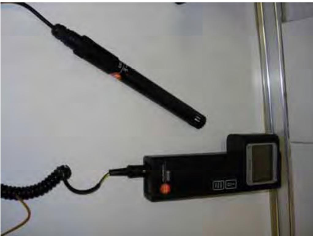
Foto 5.3. Sonda termo-higrométrica.
