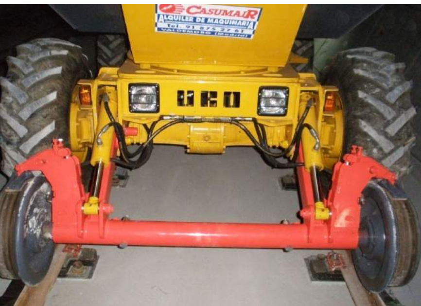
▲ Dúmpster sobre diplory con zapata.
