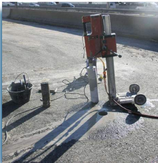
▲ Comprobación del espesor y densidad de MBC.
