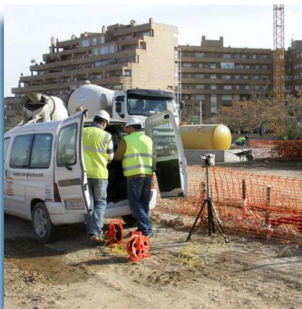
▲ Auscultación sónica de pantallas por método cross-Hole.
