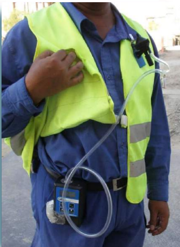
▲ Operario provisto del equipo de medición de sílice (bomba de aspiración de alto caudal).
