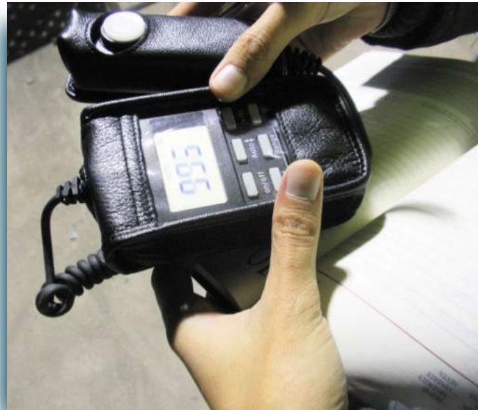
▲ Estudio de las condiciones luminotécnicas mediante empleo de luxómetro.
