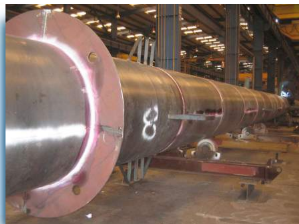
▲ Comprobación de soldadura de las camisas para pilas-pilote.
