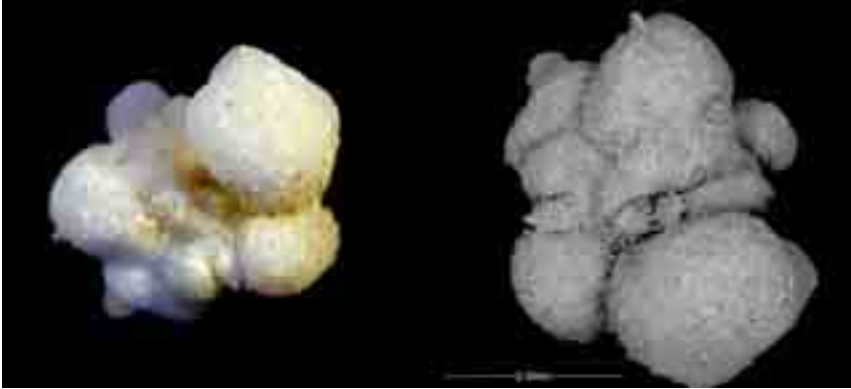
Figura 2. Eflorescencia separada del mortero perteneciente a un aljibe. Imagen de la izquierda realizada al microscopio estereoscópico (10 X). Imagen de la derecha realizada al microscopio electrónico de barrido (BSE) (20 X).
