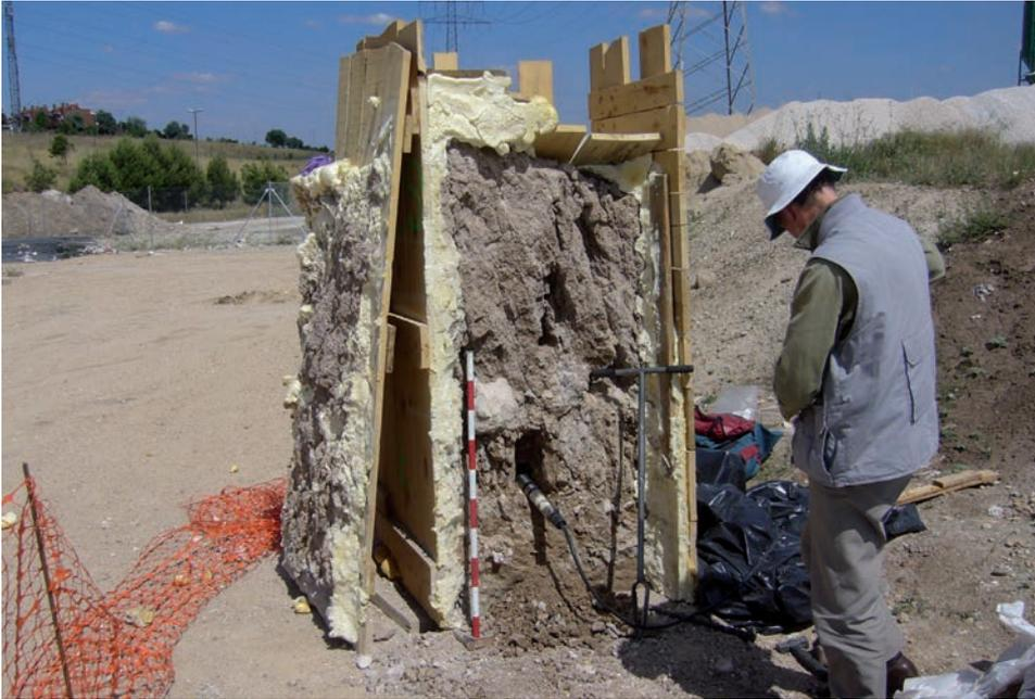
Fig. 6. Toma de muestras y medición con dosímetro para la datación por OSL del testigo extraído en Vías Colectoras Sur (Dr. Nick Debenhan).
