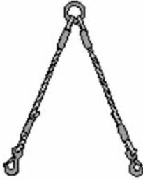
*Figura 127. Detalle de la unión de la parte superior de una eslinga de dos ramales.*
