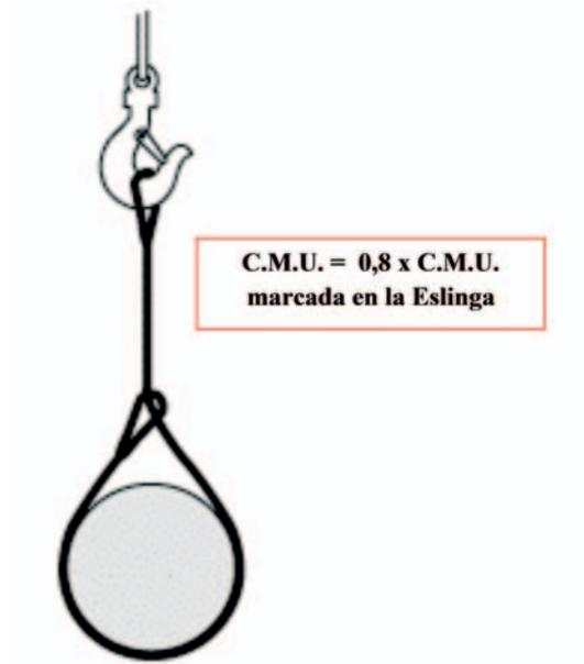
Montaje de eslinga por el sistema de **dos** eslingas simples en nudo corredizo, cuando se utiliza de esta manera la C.M.U. no debe sobrepasar de  $0,8 \times 1,4 \times$  C.M.U. de la marcada en la Eslinga, ver figura 134, para ángulos entre ramales de  $0 - 90^\circ$ .
