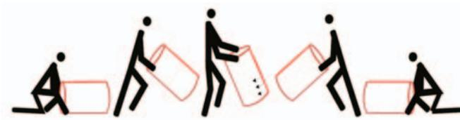
La manipulación de tubos, barras, escaleras y en general elementos longitudinales se realizará según el esquema de la figura 047.
