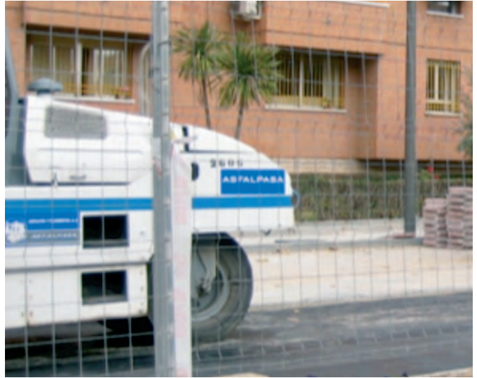
Figura 159. Equipo utilizado en tareas de asfaltado. Compactadora de neumáticos.
