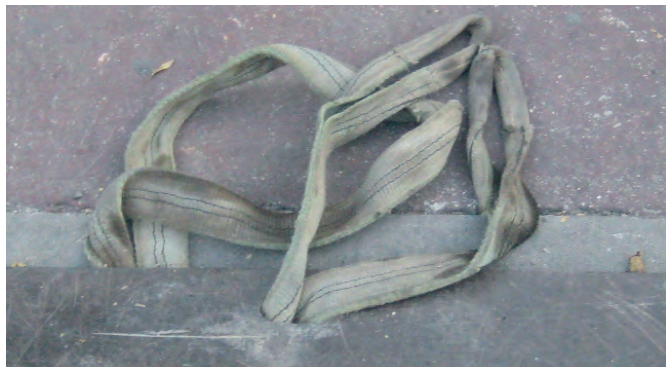
Figura 142. Eslinga preparada para levantar un chapón.
