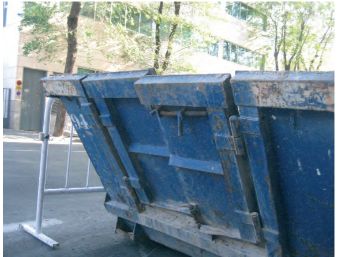
Figura 087. Contenedor con la trampilla cerrada.
