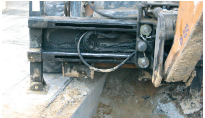
Figura 057. Apoyo sobre dos superficies de diferente resistencia.
