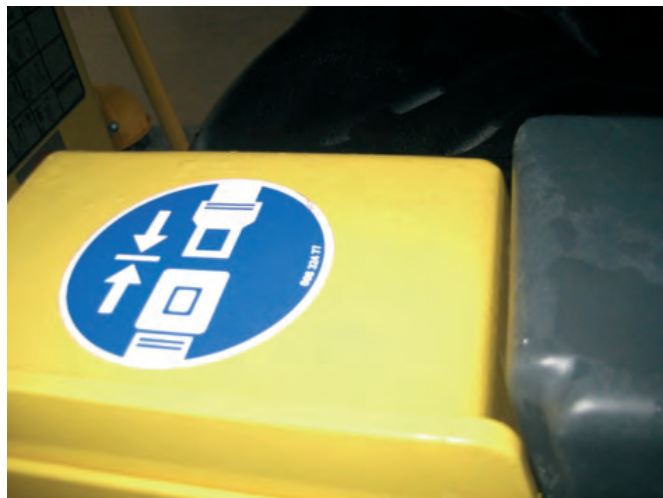
Figura 152. Señal de uso obligatorio de cinturón de seguridad.
