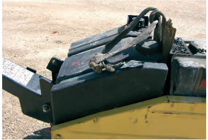
Figura 153. Eslinga, para el traslado de un equipo de compactación, de cuestionable capacidad resistente por los nudos y desperfectos existentes.
