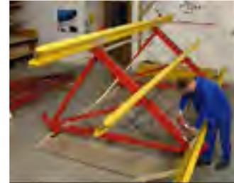
8. En otra zona, se procede al montaje del carro CB-240 (en caso de que sea necesario) sobre la consola y se conecta en sus puntos de unión a la misma.
