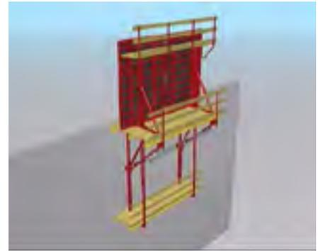
11. Limpiar los paneles, colocar la armadura, cerrar el encofrado y hormigonar la 3ª fase. Ahora comienza el ciclo regular.
