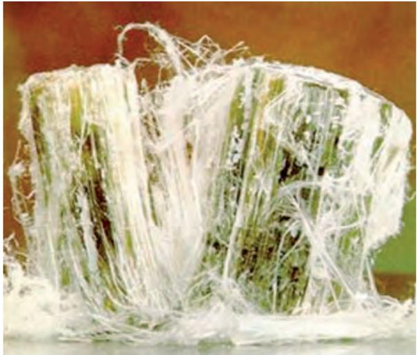
Esta variedad de amianto, constituye alrededor del 90% del amianto que se ha consumido en España, ya que ha sido empleado por los sectores del textil, mecánico, tuberías y fibrocementos.
