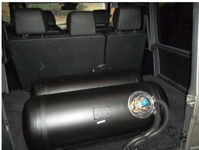
**Figura 15:** Depósito cilíndrico. Fuente: Clúster Autogas.
