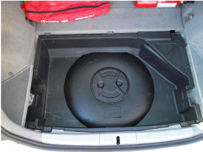
**Figura 13:** Depósito toroidal interno. **Fuente:** Clúster Autogas.
