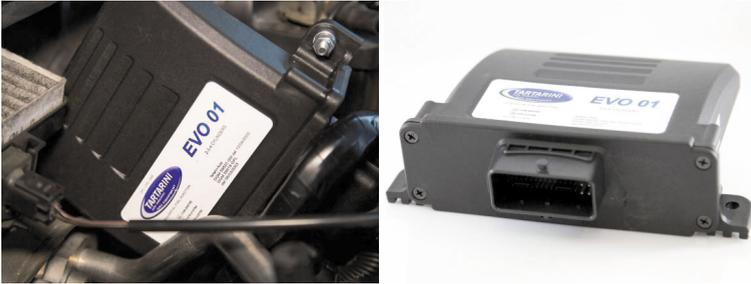
**Figura 21:** Centralita. **Fuente:** Clúster Autogas.
