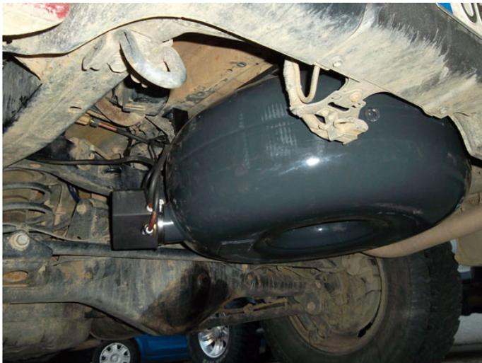
**Figura 14:** Depósito toroidal externo. **Fuente:** Clúster Autogas.
