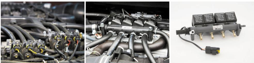
**Figura 20:** Inyectores. Fuente: Clúster Autogas.
