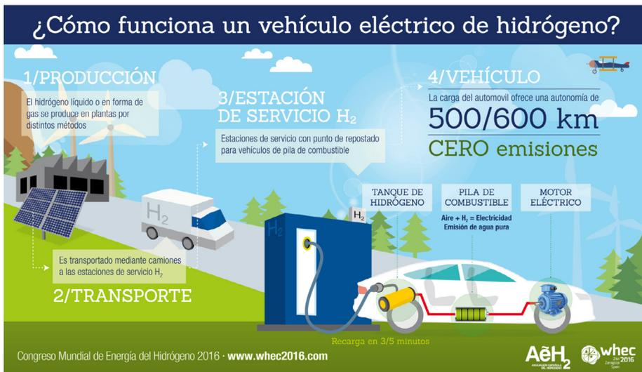
Figura 10: ¿Cómo funciona un vehículo eléctrico de hidrógeno? Fuente: AeH2.
