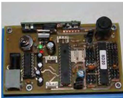
Como la alimentación se realiza con baterías, es necesario utilizar un convertidor DC/DC para que no se disipe mucha energía en calor.
