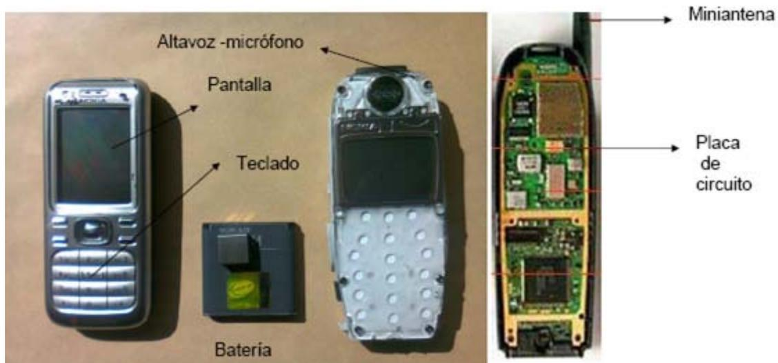
Figura nº 5. Componentes básicos de un teléfono móvil.
