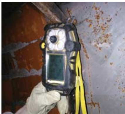
Control continuo de la atmósfera de trabajo mediante detectores con alarmas óptica y acústica. Estos instrumentos deben colocarse en la zona de trabajo.
