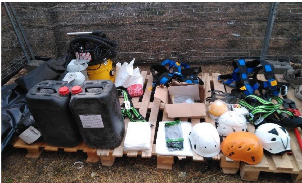
Equipos utilizados habitualmente en trabajos con materiales que contienen amianto (aspiradora, humectante, láminas plásticas y equipos de protección individual)
