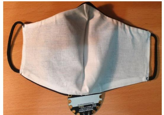
La placa irá alimentada con un portapilas de botón con interruptor. El portapilas irá también dentro, entre las capas, junto con la placa. Tras introducir placa y portapilas, se debe coser un poco la parte inferior. También se puede sujetar la placa interiormente a una capa cosiéndola gracias a los agujeros periféricos que tiene la placa.
