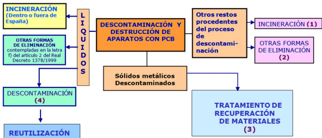
Figura 1. Proceso de tratamiento de aparatos con PCB
