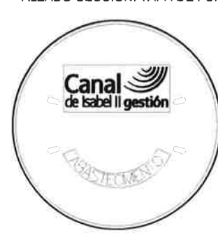
PLANTA.TAPA DE FUNDICIÓN
