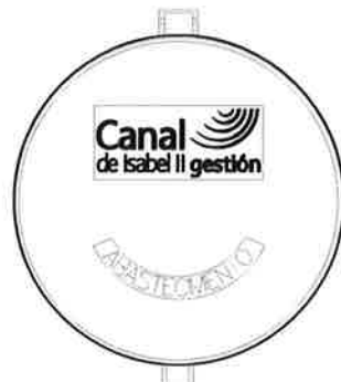
PLANTA.TAPA DE FUNDICIÓN
