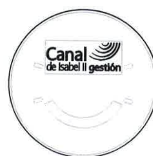
PLANTA.TAPA DE FUNDICIÓN
