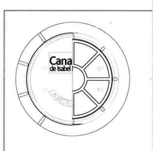
PLANTA-SECCIÓN. TAPA DE FUNDICIÓN
