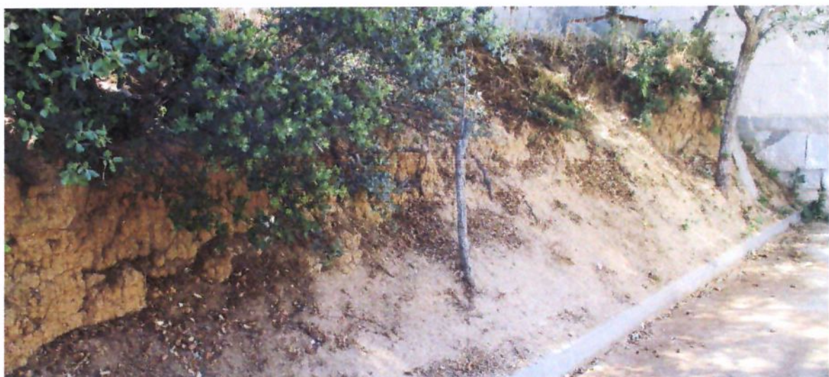
F.7. Vista del terreno en un pequeño desmonte en el extremo norte de la calle de la Paloma. Suelos areno-arcillosos con gravillas.
