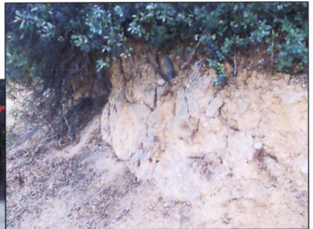
F.4/F.5. Otra vista de la Avda. del Valle. Antes de la curva del fondo se cruza la misma vaguada anterior. Detalle de los suelos areno-arcillosos con cantos de la zona en un pequeño desmonte.
