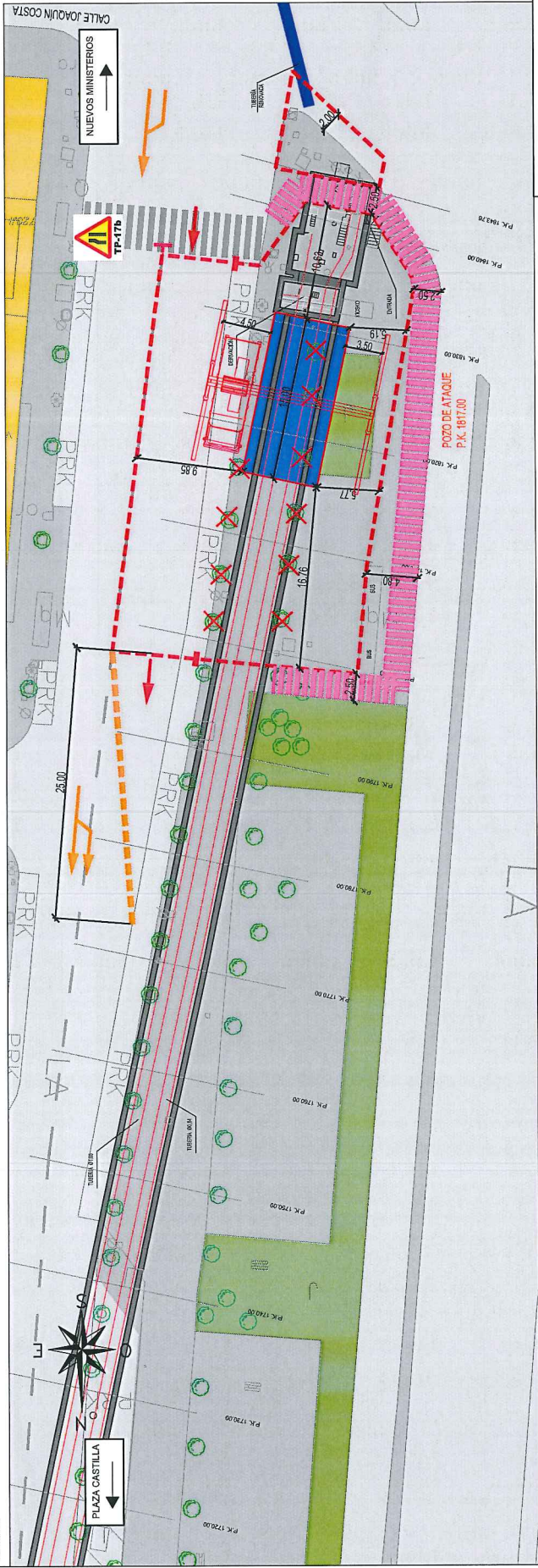
Fase 4: Extracción por tramos de la tubería existente, retirada de la entibación provisional, construcción de la nueva galería y colocación tubería nueva. ESCALA: 1:500
