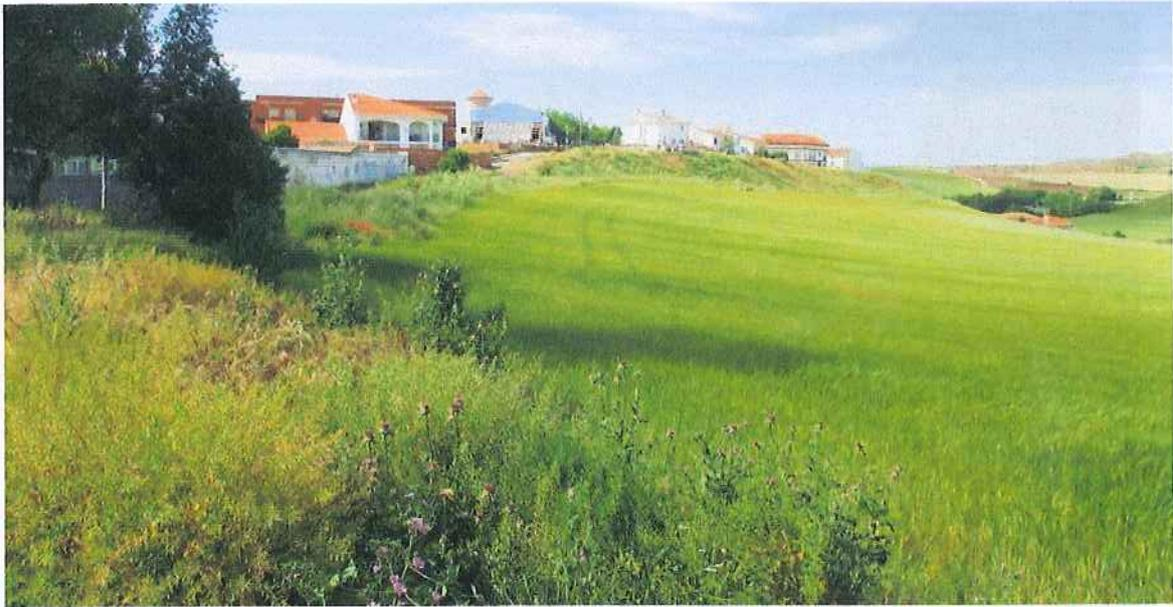
**F.1. Panorámica del Este del casco urbano, en el que se desarrolla el proyecto. Campos sobre coluviones a la derecha, escarpe y talud con afloramientos del sustrato terciario y zona alta edificada sobre depósitos de glaciares.**
