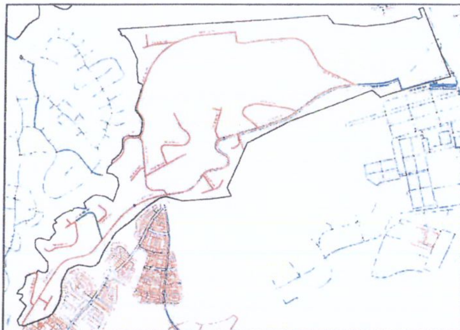
Esquema de red de distribución propuesta. Red de gravedad. — Ø 80 mm. — Ø 100 mm. — Ø 150 mm. — Ø 200 mm.
