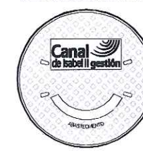
PLANTA.TAPA DE FUNDICIÓN
