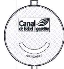
PLANTA.TAPA DE FUNDICIÓN
