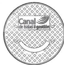
PLANTA. TAPA DE FUNDICIÓN ESCALA 1:20
