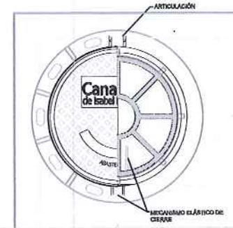
TAPA Y MARCO CON BISAGRA Y CON DISPOSITIVO DE ACERROJADO Y ANTIRROBO
