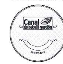
PLANTA.TAPA DE FUNDICIÓN
