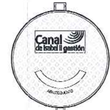
PLANTA.TAPA DE FUNDICIÓN
