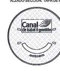
PLANTA, TAPA DE FUNDICIÓN
