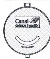
PLANTA, TAPA DE FUNDICIÓN
