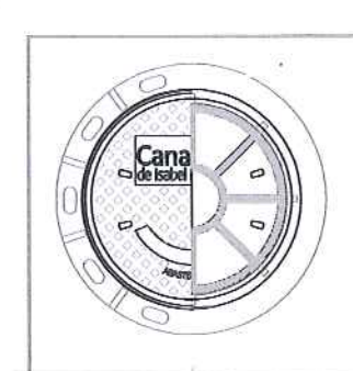
PLANTA-SECCIÓN. TAPA DE FUNDICIÓN
