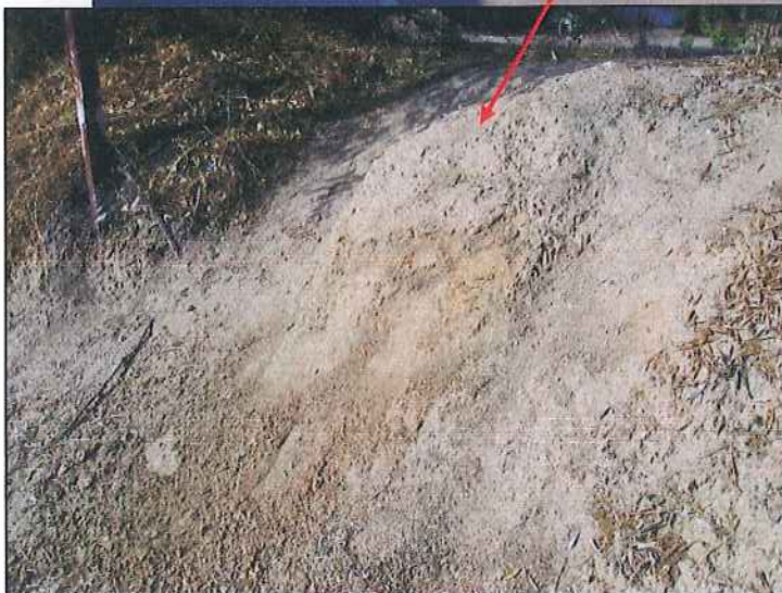
F.2. Pequeño desmonte en la margen Oeste de la carretera de San Martín de Valdeiglesias. Detalle de suelos residuales arenosos (jabre) con restos de roca en descomposición.
