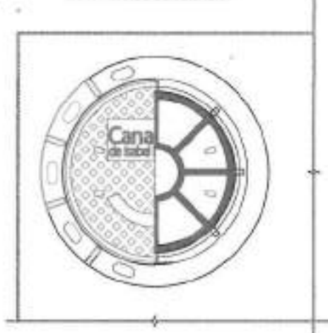
PLANTA SECCIÓN TAPA DE FUNDICIÓN
