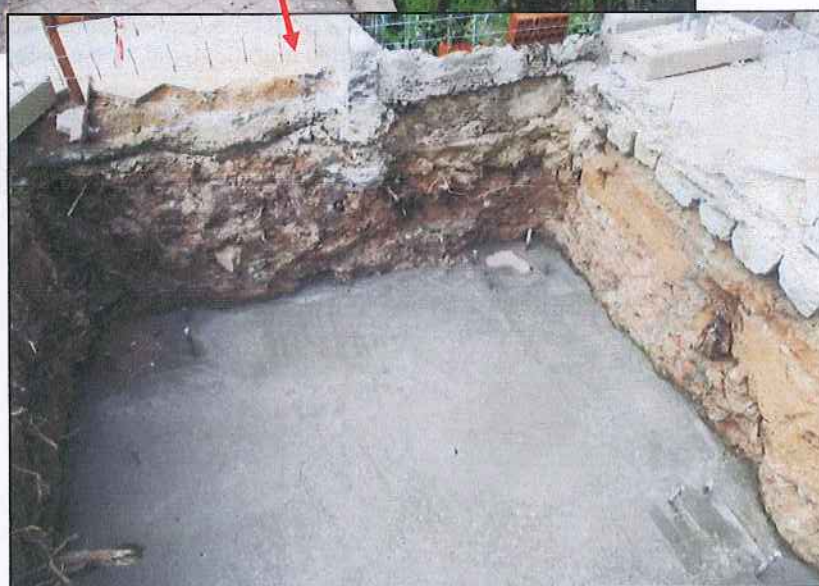
F.4/F.5. Zona ajardinada junto a un bloque. Detalle de pequeña excavación: rellenos superficiales sobre sustrato arenoso (el sustrato no se ve en la foto pero se comprobó en el contenedor del terreno excavado).
