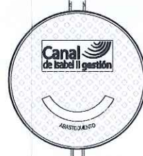
PLANTA.TAPA DE FUNDICIÓN
