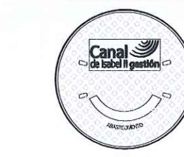
PLANTA.TAPA DE FUNDICIÓN
