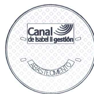
PLANTA. TAPA DE FUNDICIÓN
