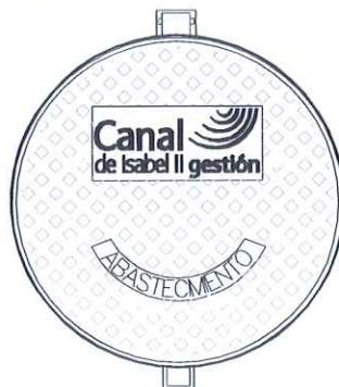
PLANTA. TAPA DE FUNDICIÓN
