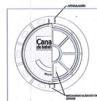
TAPA Y MARCO CON BISAGRA Y CON DISPOSITIVO DE ACERROJADO Y ANTIRROBO
