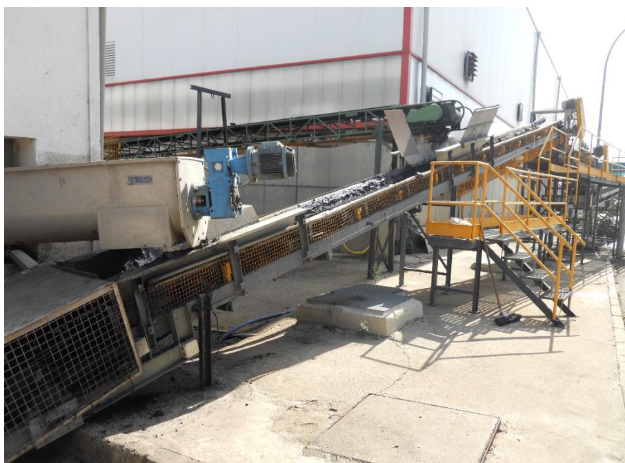
Salida de fangos a secado térmico
