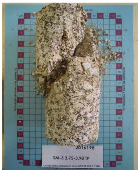
Foto de la muestra sometida a ensayo
