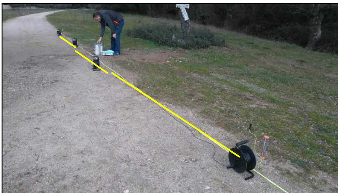
Figura 3. Vista de los 4 electrodos formando el dispositivo simétrico de Wenner Cada una de las tres líneas amarillas mide lo mismo y es el parámetro "a".
