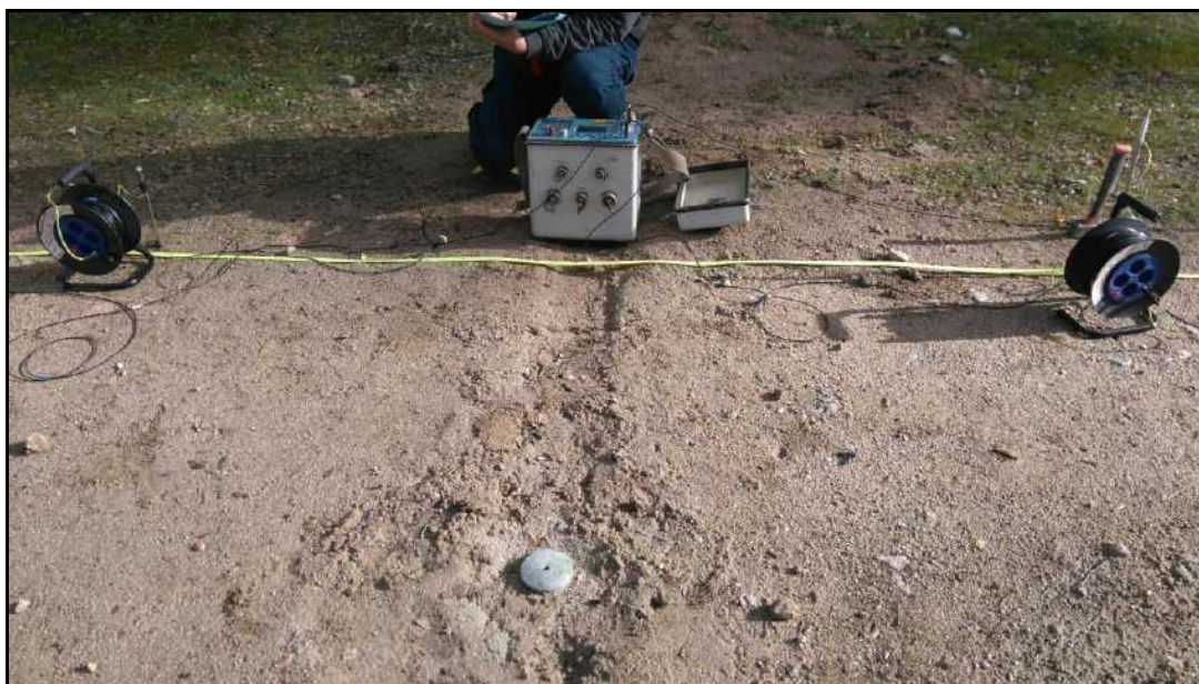
Figura 4. Dispositivo de medida de resistividades en el punto 1, junto al sondeo.
