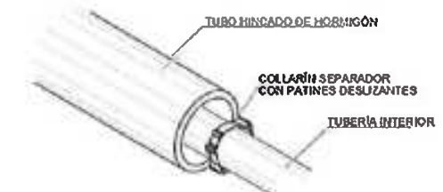
DETALLE INTRODUCCIÓN TUBERÍA INTERIOR EN TUBO HINCADO S/E
